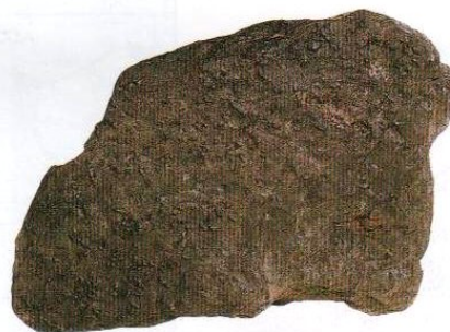
20 Xisto mosqueado. Esta rocha metamórfica forma-se quando se dão pressões elevadas e temperaturas médias.
